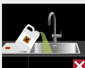
Halten Sie heißes Fett, Farben oder chemische Flüssigkeiten von Ihrer Spüle fern. Kontakt mit Chemikalien, Säuren, Speiseresten und rostigen Gegenständen kann die Schutzschicht des Edelstahls beschädigen und zu irreparablen Schäden an der Spüle führen. Kommt Ihre Spüle dennoch mit diesen Mitteln in Berührung, entfernen Sie diese bitte sofort und spülen die Spüle anschließend gründlich mit Wasser nach.
